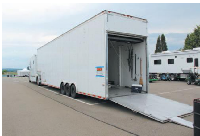
▲ Ça, c'est une semi-remorque spécialisée pour le transport de voitures de course.
