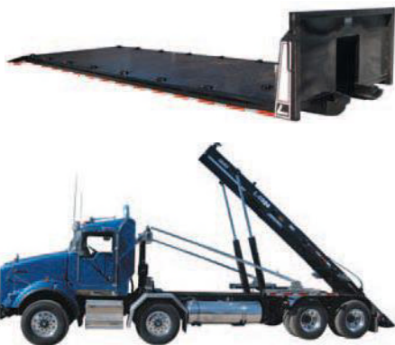
▲ On retrouve sur ce véhicule le système 60,000lb L-6024 sur un camion 24 pieds de long avec l'extension arrière, l'unité de contrôle à l'intérieur de la cabine et le rouleau à toile Roll-Rite.
