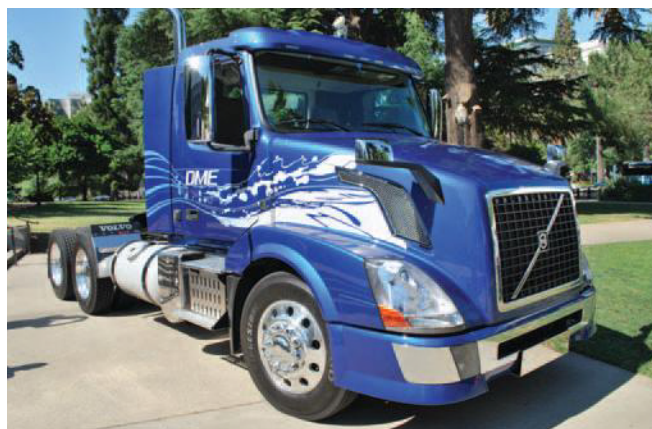
▲ Un des camions VNL de Volvo équipé d'un moteur D13 qui sera utilisé dans le cadre des essais de DME comme carburant pour les véhicules lourds.
