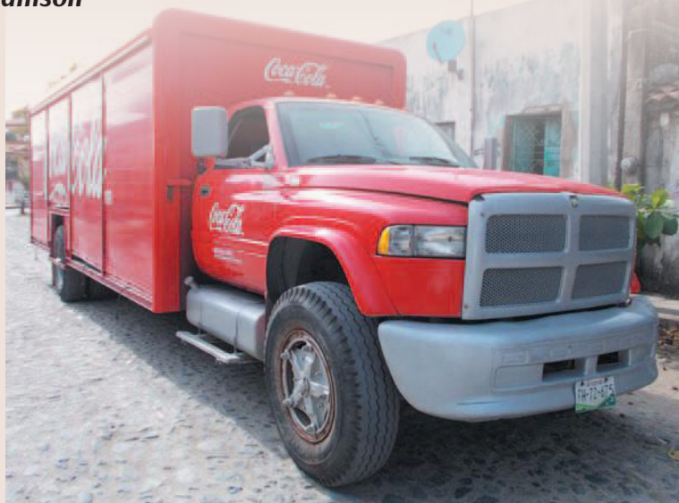
> Cet imposant poids lourd Dodge de l'embouteilleur Coke est équipé d'une cabine de l'avant dernière génération de Ram, un modèle unique au marché mexicain. Notez la calandre au dessin tout aussi unique et le massif pare-chocs qui semble être de matière plastique.
