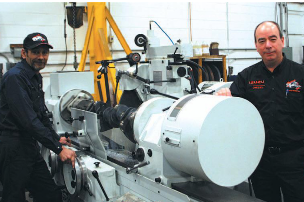
> Jérôme St-Amour, une personne possédant 38 ans de métier, est photographié ici en compagnie du directeur de l'usine de la Rive-Sud, Marc Fontaine, à côté d'une nouvelle machine pour tourner les vilebrequins.
